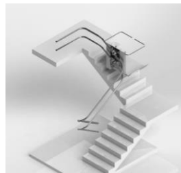
Figura 08 - Interação entre os trilhos, escada e plataforma
